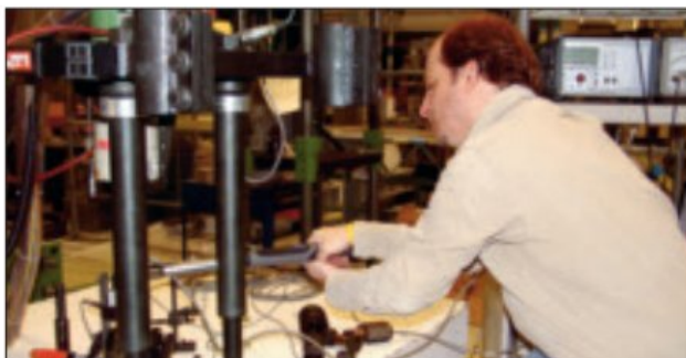
Vorbereitung eines dynamischen Dübel-Auszugversuchs im gerissenen Beton.
